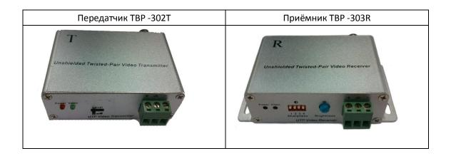
ТВР-302Т/303R - новая модель активного передатчика (Т) и приёмника (R) для передачи видео или других сигналов на большие расстояния. При совместном использовании передатчик и приёмник обеспечивают передачу сигналов на расстояние до 2400м по кабелю UTP.
