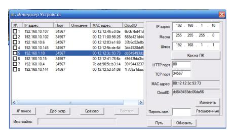
Для изменения IP-адреса устройства необходимо выбрать его левой кнопкой мыши в списке, затем в окнах **IP адрес**, **Маска**, **Шлюз** задать новые значения. Нажатие кнопки **Как на ПК** установит маску сети и адрес шлюза такие же, как на компьютере. Для ограничения доступа к настройкам устройства, можно задать пароль в окне **Пароль адм.** Нажатие **Изменить** установит новые значения настроек устройства.
