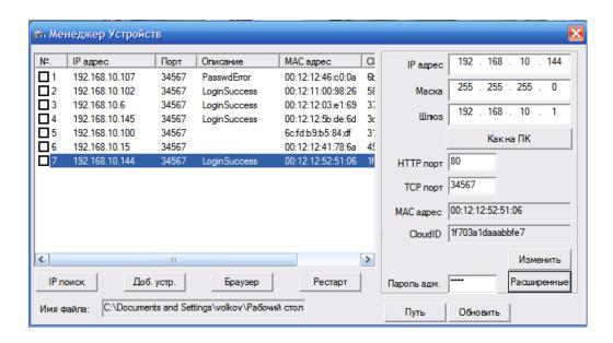
В списке найденных совместимых устройств, подключённых к сети, показаны их сетевые адреса, порты основного потока, описание (статус подключения), МАС-адреса и серийные номера CloudID (для подключения через «облако»).
