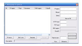
Для поиска устройств, подключённых к сети, нажмите **IP поиск.** После сканирования появится список найденных совместимых сетевых устройств (IP-камер, DVR, NVR), например:
