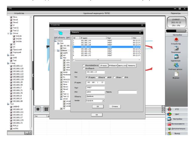
Дважды щелкните левой кнопки мыши по нужной камере для подключения к ней. Затем нажмите справа внизу кнопку **Настройки** и выберите **Удаленные**, в открывшемся окне **Конфигурации устройства** выберите нужную камеру в списке устройств. В открывшемся меню камеры войдите в меню **Настройки – Сеть** или **Настройки – Сетевые службы**.
