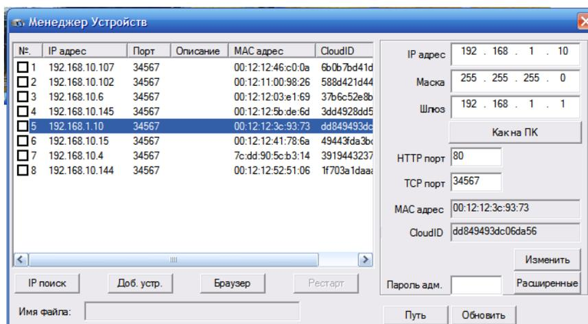
Для изменения IP-адреса устройства необходимо выбрать его левой кнопкой мыши в списке, затем в окнах **IP адрес**, **Маска**, **Шлюз** задать новые значения. Нажатие кнопки **Как на ПК** установит маску сети и адрес шлюза такие же, как на компьютере. Для ограничения доступа к настройкам устройства, можно задать пароль в окне **Пароль адм.** Нажатие **Изменить** установит новые значения настроек устройства.
