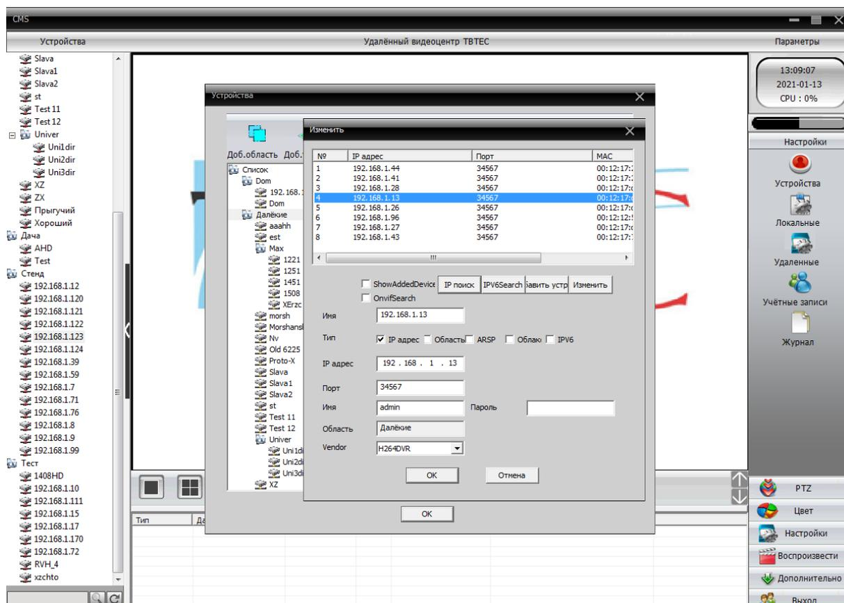
Дважды щелкните левой кнопкой мыши по нужной камере для подключения к ней. Затем нажмите справа внизу кнопку **Настройки** и выберите **Удаленные**, в открывшемся окне **Конфигурации устройства** выберите нужную камеру в списке устройств. В открывшемся меню камеры войдите в меню **Настройки – Сеть** или **Настройки – Сетевые службы**.
