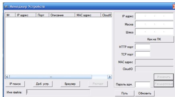
Для поиска устройств, подключённых к сети, нажмите **IP поиск**. После сканирования появится список найденных совместимых сетевых устройств (IP-камер, DVR, NVR), например:
