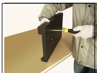
4. закрутите винты жесткого диска
